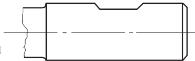
Codolo cilindrico con piano di trascinamento Parallel shank with flat Queue cylindrique à méplat
