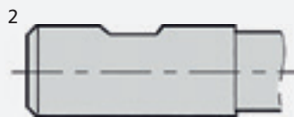
DIN 1835 B/DIN 6535 HB bis \varnothing 20 mm
